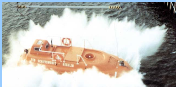
Chantier naval Rechlin - GAL-bateau à l'immerger dans de l'eau
